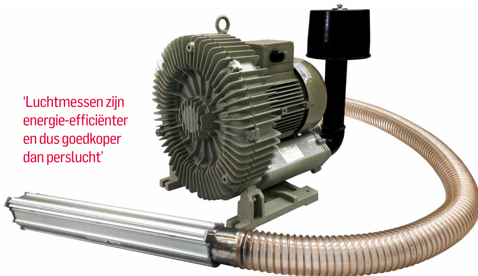
Dovac luchtmes aangesloten op een zijkanaalblower met een inlaat voorzien van een aanzuigluchtfilter.
