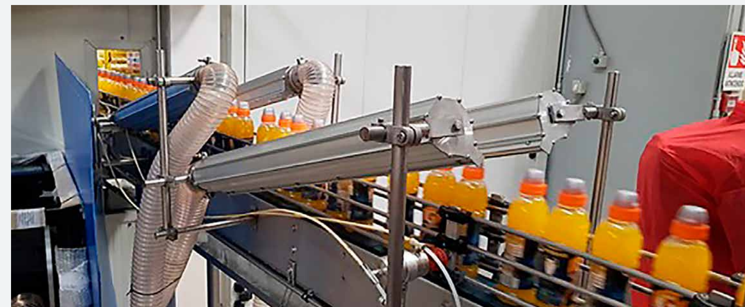
Luchtmessen voor het gericht droogblazen van flesjes voordat ze een etiket krijgen.
